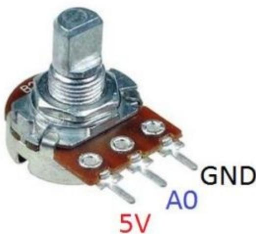
Переменный резистор или потенциометр – это электрическое устройство, значение уровня сопротивления которого можно задать в определенных пределах. Таким образом мы можем менять параметры электрических схем, гибко подстраивая их под определенные условия: например, регулировать чувствительность датчика или громкость звука в динамике. Потенциометры получили широкое распространение в схемах регулировки громкости, напряжения, контрастности и т.д., за свою простоту и практичность.
